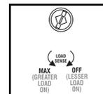
*Remarque : Le réglage en usine est la rotation complète du cadran dans le sens horaire. Cependant, en fonction du seuil de charge auquel vous voudriez que l'onduleur réponde, vous devez régler le cadran dans le sens antihoraire pour réduire sa sensibilité jusqu'à ce que l'onduleur soit actif seulement quand l'équipement et les appareils connectés sont réellement en usage.*
