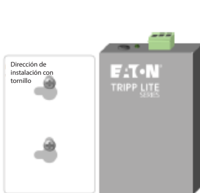
Instalación en Dirección Recta
