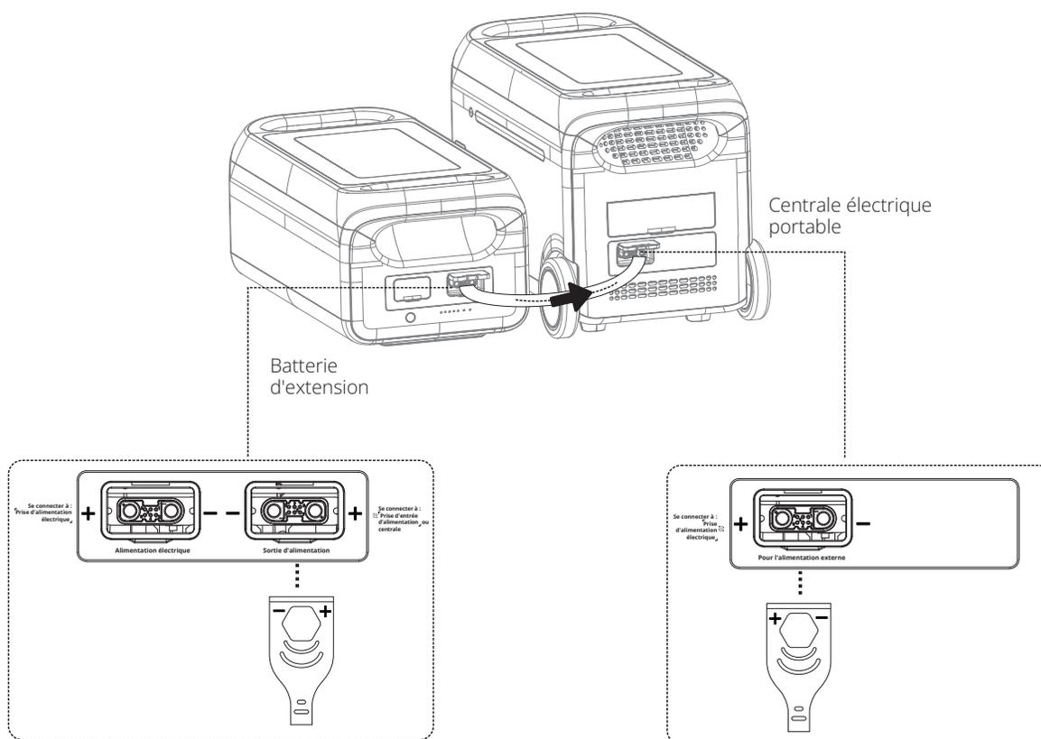
**Remarque :** les symboles + et - sont apposés sur les batteries et les câbles afin de réduire les risques d'inversion de polarité.
