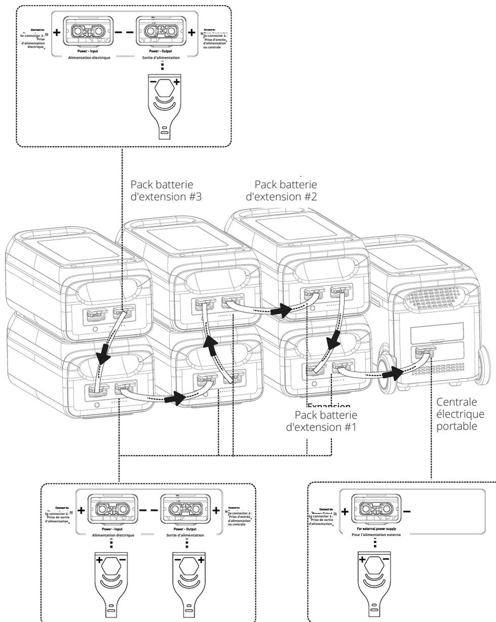
**Remarque :** les symboles + et - sont apposés sur les batteries et les câbles afin de réduire les risques d'inversion de polarité.
