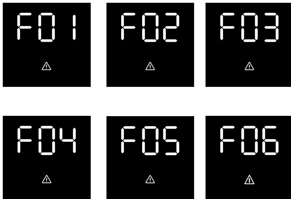
**F01. CORTOCIRCUITO DE SALIDA, CORTE DE SALIDA.**
