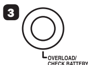
3 Voyant DEL « SURCHARGE/ CONTRÔLE DE BATTERIE »
