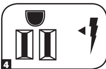
Salidas protegidas sólo contra sobretensiones
