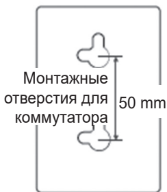
Схема монтажных отверстий для мод. NGI-U05
