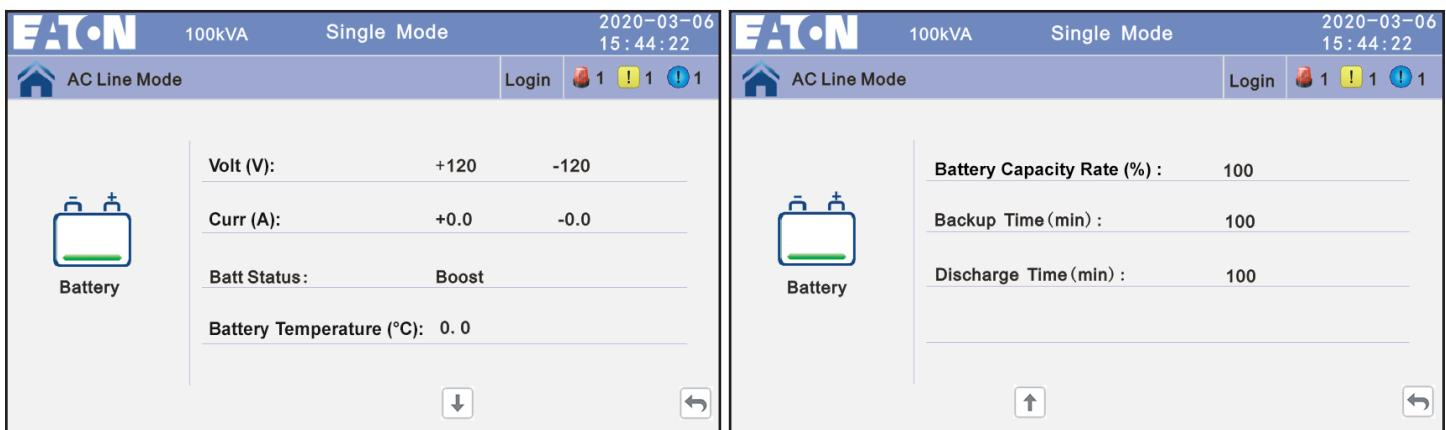
Figure 4-13 : Fenêtre d'affichage des données des batteries
