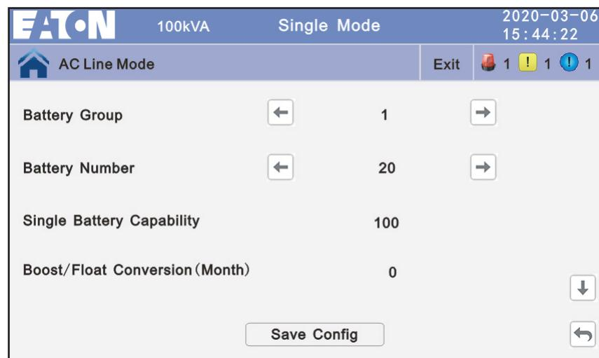
Figure 4-31A : Réglages des batteries
