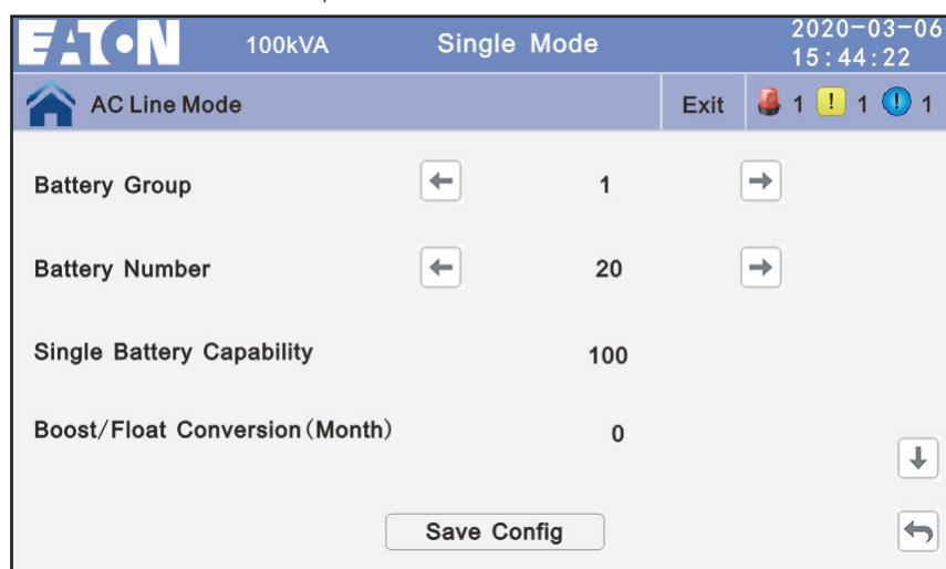
Figura 4-31A: Parámetros de la Batería
