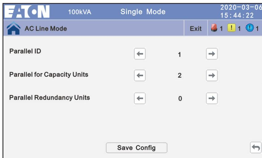
Figure 4-29 : Réglages du mode en parallèle
