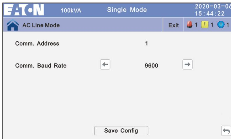
Figure 4-25 : Réglages de la communication
