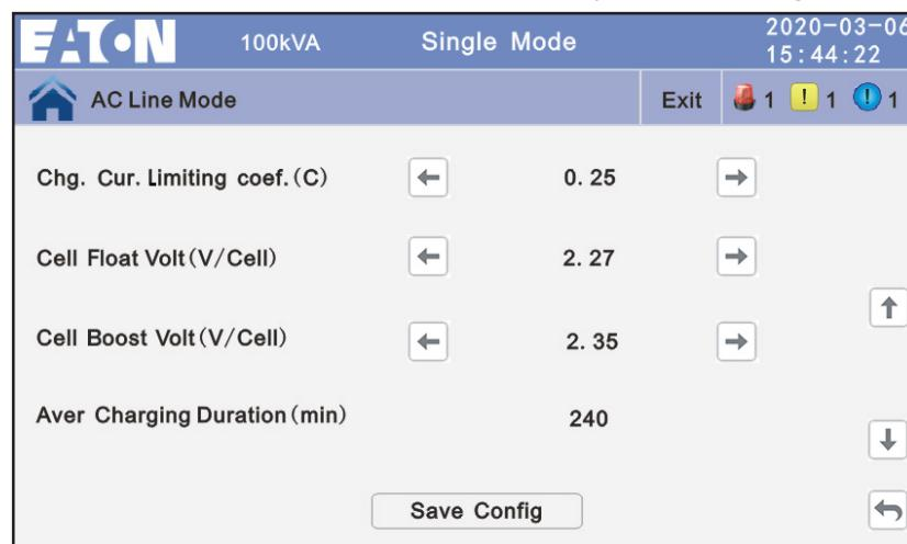
Figura 4-31B: Parámetros de la Batería
