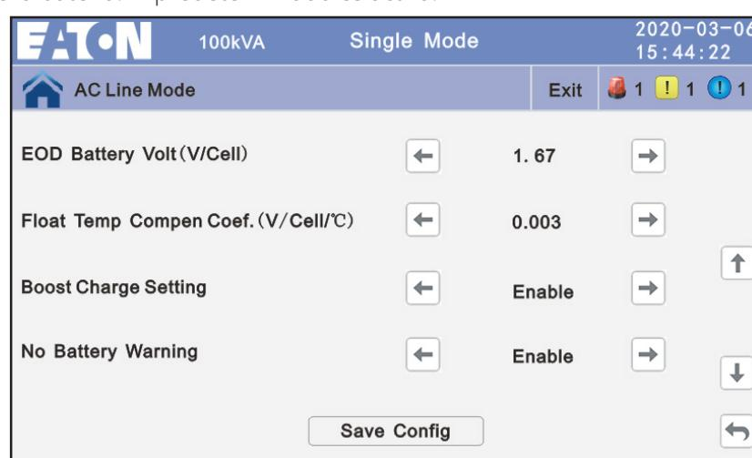
Figura 4-31C: Parámetros de la Batería
